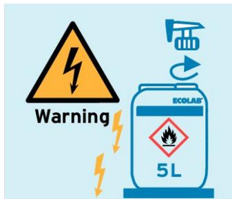
7. Attention : Lire attentivement les consignes de sécurité ci-dessous. Vérifier la mise à la terre avant de manipuler/d'ouvrir les bidons. Ouvrir le bidon de 5 L uniquement pour effectuer la procédure de remplissage et visser le robinet de remplissage. Placer le bidon sur le côté, en position élevée (la vanne en position la plus basse).
