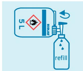
8. Penser à placer un bac d'égouttage autour du bidon et des flacons. Ouvrir le robinet et remplir le flacon de recharge. Transvaser toujours dans un flacon muni d'une étiquette indiquant le nom du produit, les informations sur la durée de conservation et la date de remplissage.
